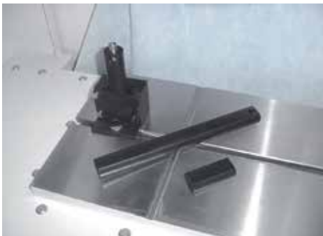
Porte-diamant avec inserts amovibles (90, 150, 300 mm) pour un dressage périphérique et latéral efficace et pour le calibrage.
