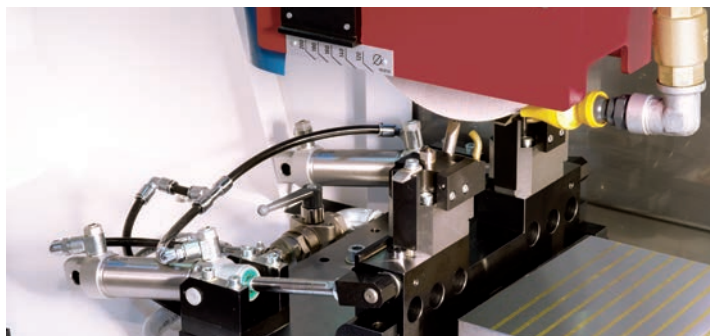
Dispositif de dressage relevable pour le dressage périphérique, latéral et de profils. La meule de rectification et le capot de protection ne peuvent pas entrer en collision avec le dispositif de dressage par actionnement pneumatique.
