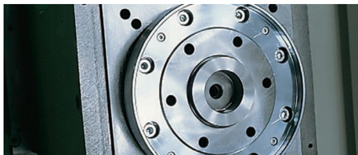
Broche rétractable avec attachement plat pour un positionnement reproductible des meules
