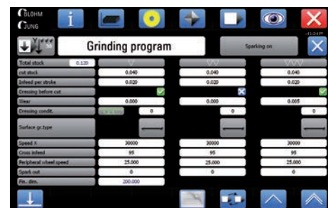
Cycle automatique sur 3 postes : ébauche, finition, finissage avec cycles de dressage intégrés. La description du cycle complet exige peu de paramètres.
