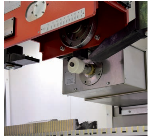
Broche supplémentaire pour rectification horizontale , 18.000 \text{min}^{-1} ; 13 kW
