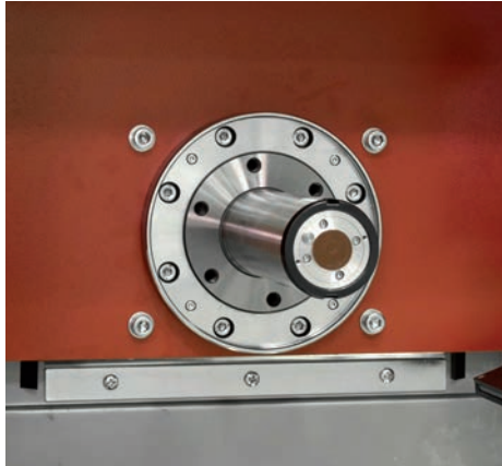
Equilibreur automatique de meule intégré au niveau de la broche de rectification
