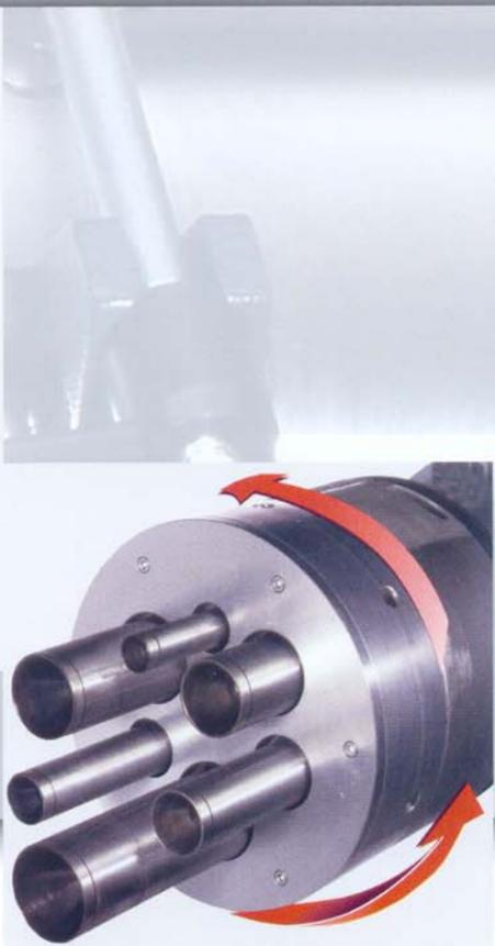
Le Super Hydrobar HS est pourvu d'une bague d'indexage avec un levier pour sélectionner rapidement le tube de guidage approprié au diamètre de la barre à usiner. Il suffit d'indexer le tube dans la position correspondant au nouveau diamètre à usiner et le tour est joué. L'appareil est équipé d'un système électromécanique de détection de fin de barre.
