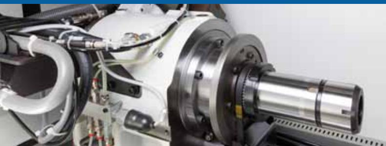
Avec un alésage de broche de  $\varnothing 33$  mm ou  $\varnothing 37$  mm, les barres de 26 mm ou 32 mm ne nécessitent aucune préparation.
