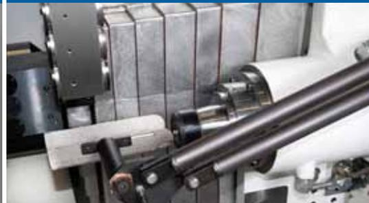
Le récupérateur de pièces dont le mouvement passe sous la broche de reprise, permet de récupérer les pièces aussi bien côté canon que côté broche de reprise.
