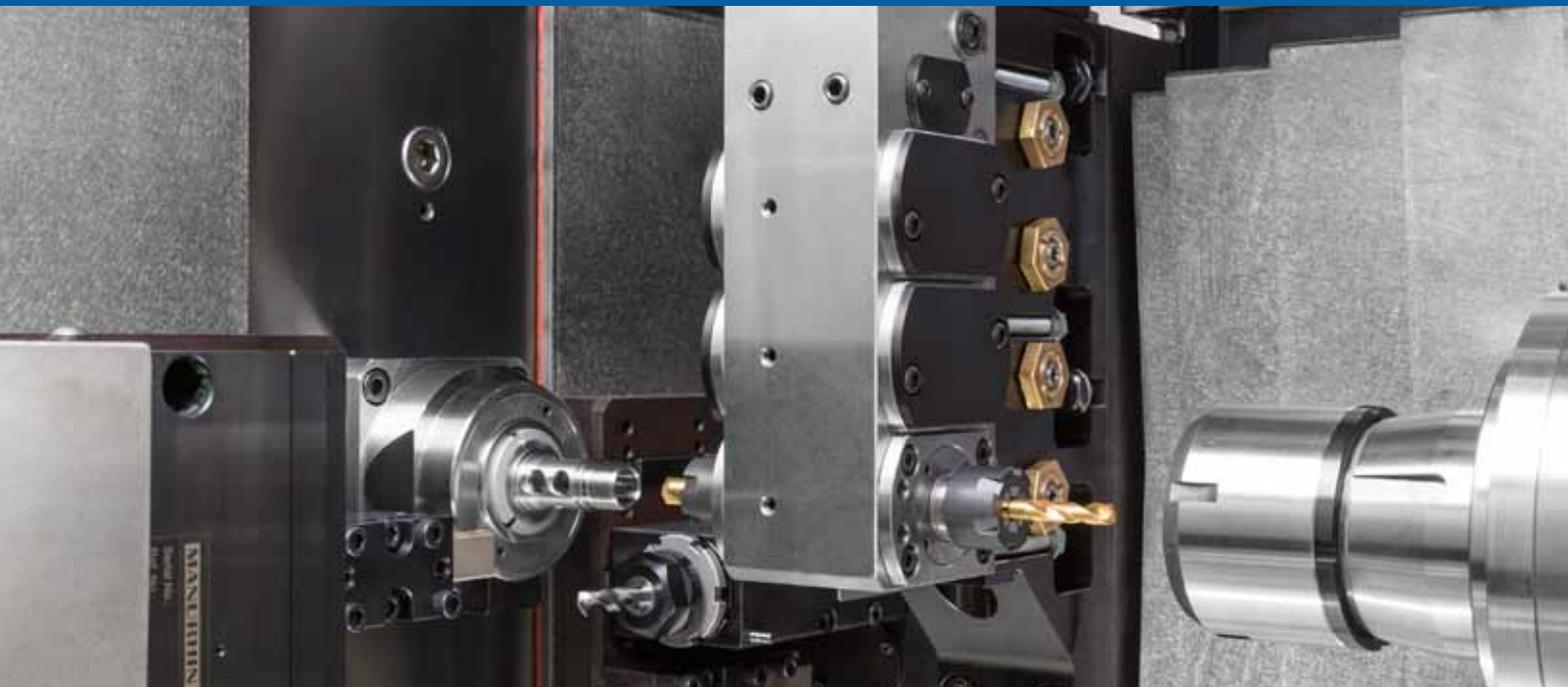
La version entraînée de l'appareil en bout offre 2 x 3 postes motorisés. Il est possible de travailler avec des outils combinés, c'est-à-dire de monter un outil entraîné d'un côté et un outil fixe de l'autre. L'efficacité de l'appareil-en-bout est renforcée par les options « arrosage à travers outil » et « arrosage haute pression ». Sa particularité : l'arrosage à travers l'outil, avec ou sans haute pression, peuvent être utilisés sur les outils-tournants grâce au joint tournant.
