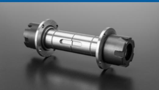
Les porte-outils tournants sont directement montés sur l'appareil en bout et entraînés par l'intermédiaire de clavettes. Leur vitesse de rotation maximale est de 8.000 tr/min.
