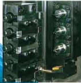
Des performances accrues grâce à une architecture complète permettant d'usiner simultanément avec 4 outils.
