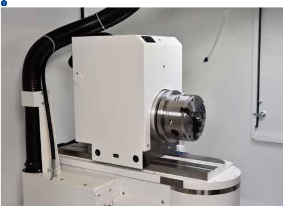
Équipée de paliers spéciaux, la poupée porte-pièce de haute précision garantit une précision de concentricité des plus élevées. Le nez de la broche A4/CM5 satisfait aux exigences de la norme DIN/ISO 702-1. Le dispositif de relèvement pneumatique facilite le déplacement de la poupée porte-pièce lors du réglage et du réajustage. Un axe C de haute précision, doté d'un système de mesure directe sur la broche porte-pièce, est disponible pour la rectification de formes et de filets.
