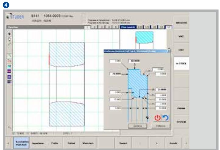
La commande de la machine est équipée du système d'exploitation StuderSIM. Ce système d'exploitation spécialement mis au point pour les applications de la rectification intérieure permet de programmer tous les cycles de base pour la rectification, le dressage et la mesure en assistance au processus. Les cycles de base, tels que la rectification de surfaces planes, d'alésages, de cônes et de filets, ainsi que le dressage et la mesure, sont définis dans des fenêtres de saisie de paramètres.
