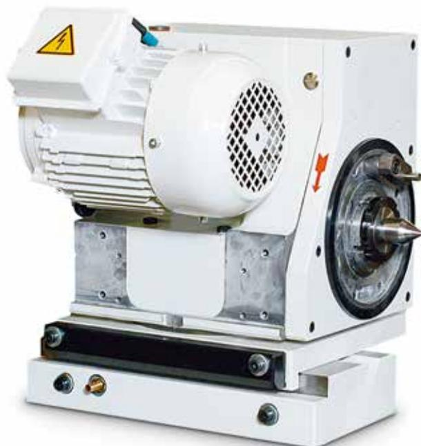
La poupée porte-pièce pivotante sur paliers hydrodynamiques permet aussi bien la rectification entre pointes que la rectification en l'air. La broche de la poupée porte-pièce tourne dans un palier hydrodynamique. La précision de circularité lors de la rectification en l'air atteint 0,0003 mm ou 0,0001 mm en option. La poupée porte-pièce est entraînée par un moteur CA étagé.
