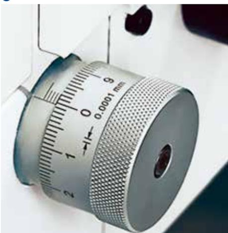
La contre-poupée rigide est équipée d'un fourreau aux dimensions généreuses pour le serrage des pointes CM3. Le fourreau est monté sur palier lisse. La pression des pointes peut être réglée de manière précise. Le réglage micrométrique permet de corriger facilement et rapidement la cylindricité (en option), étape indispensable dans l'usinage de pièces de haute précision.
